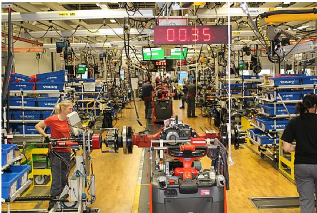
Den nya monteringslinen för bakaxlar
